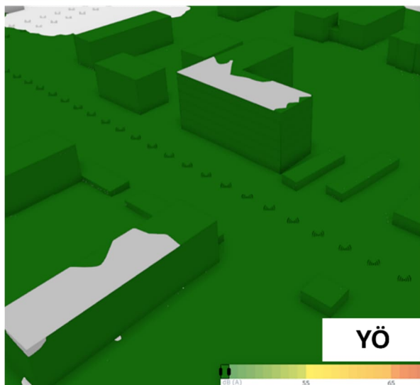
Kuva 3. Karttaotteet Forma-ohjelmistolla tehdystä tie-, katu- ja raideliikenteen melumallinnuksesta rakennuksen julkisivuun kohdistuvista melutasoista päivä-, ilta- ja yöaikana. Suunnittelualueen osalta rakennusmassoittelussa on käytetty kaavan viitesuunnitelman aineistoja. (Järvenpään kaupunki 2025).
